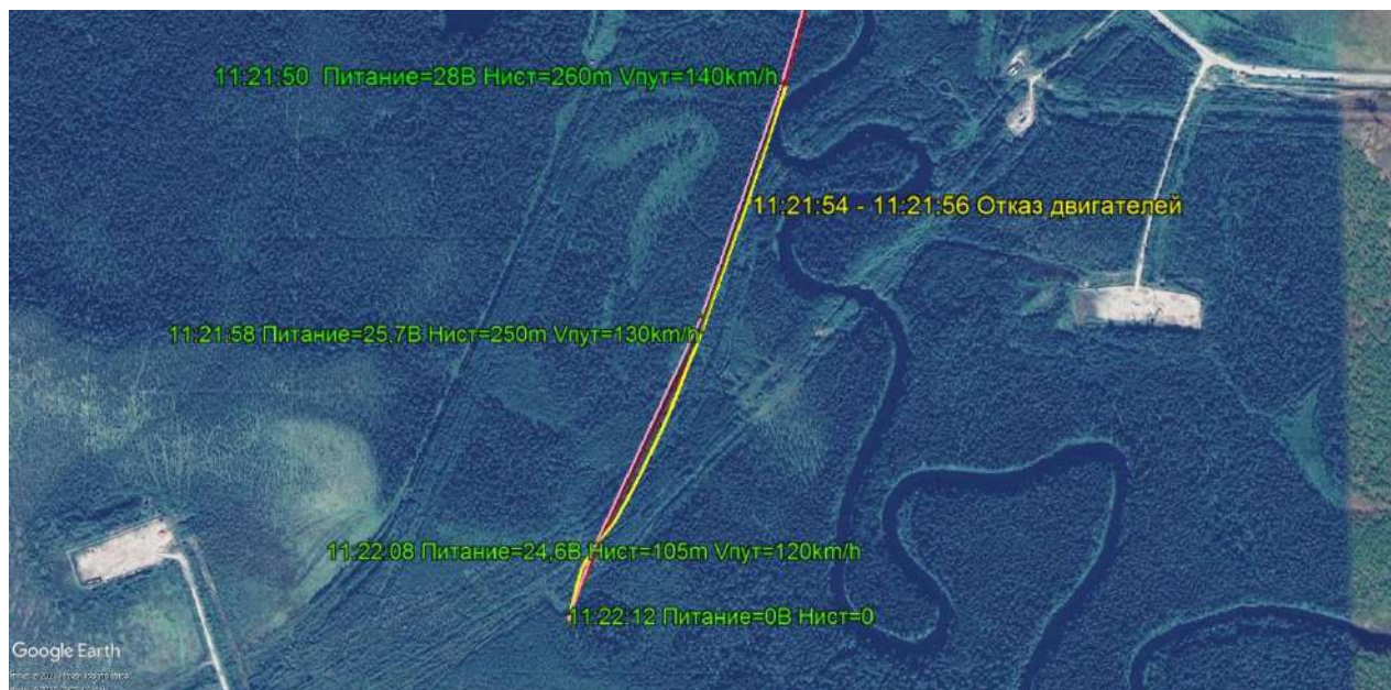
Рис. 20 Траектория полета вертолета после отказа двигателей по данным терминала ADM300 (желтым цветом показана уточненная траектория)
